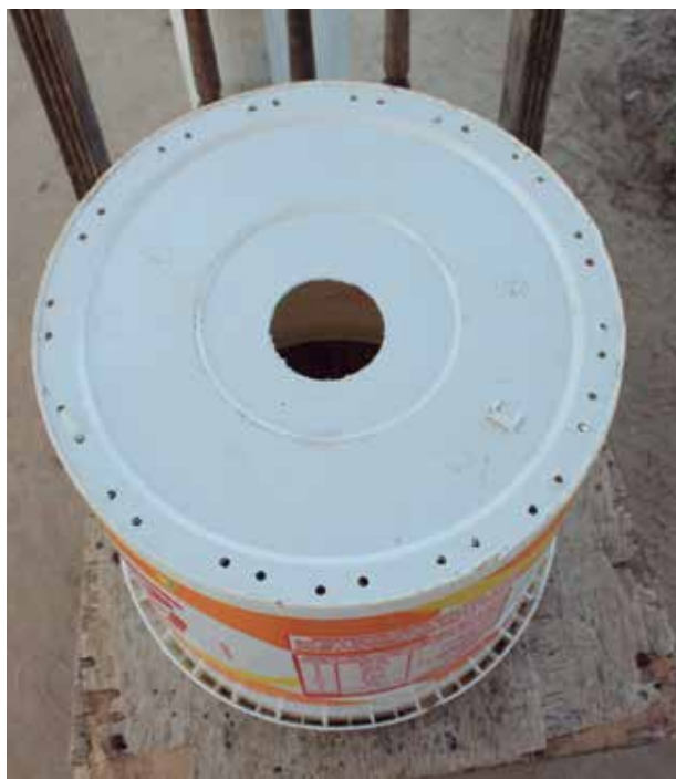
Balde do biofiltro com furos de 2 mm ao redor, espaçados a cada 2 cm. Os furos são utilizados para prender as cordas desfiadas que formam a cabeleira
