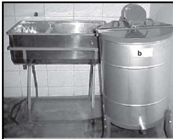
Figura 3.25 - Equipamentos utilizados na extração do mel: (a) Mesa desoperculadora e (b) Centrífuga.
